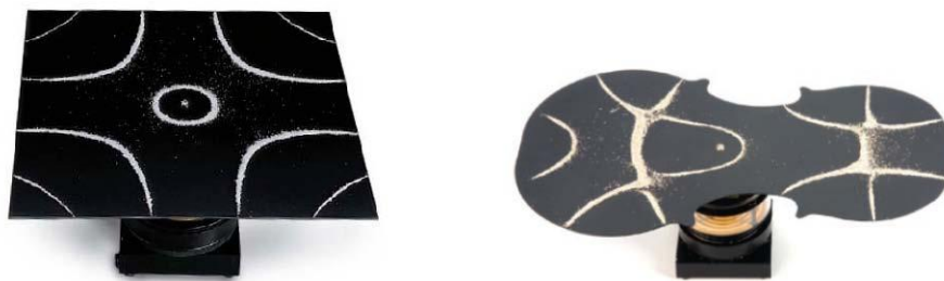
圖10、二維克拉尼共振實驗裝置圖。
