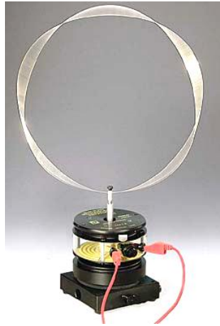
圖8、環形彈性線共振實驗架設圖，圖中顯示 n = 5 時的駐波。
